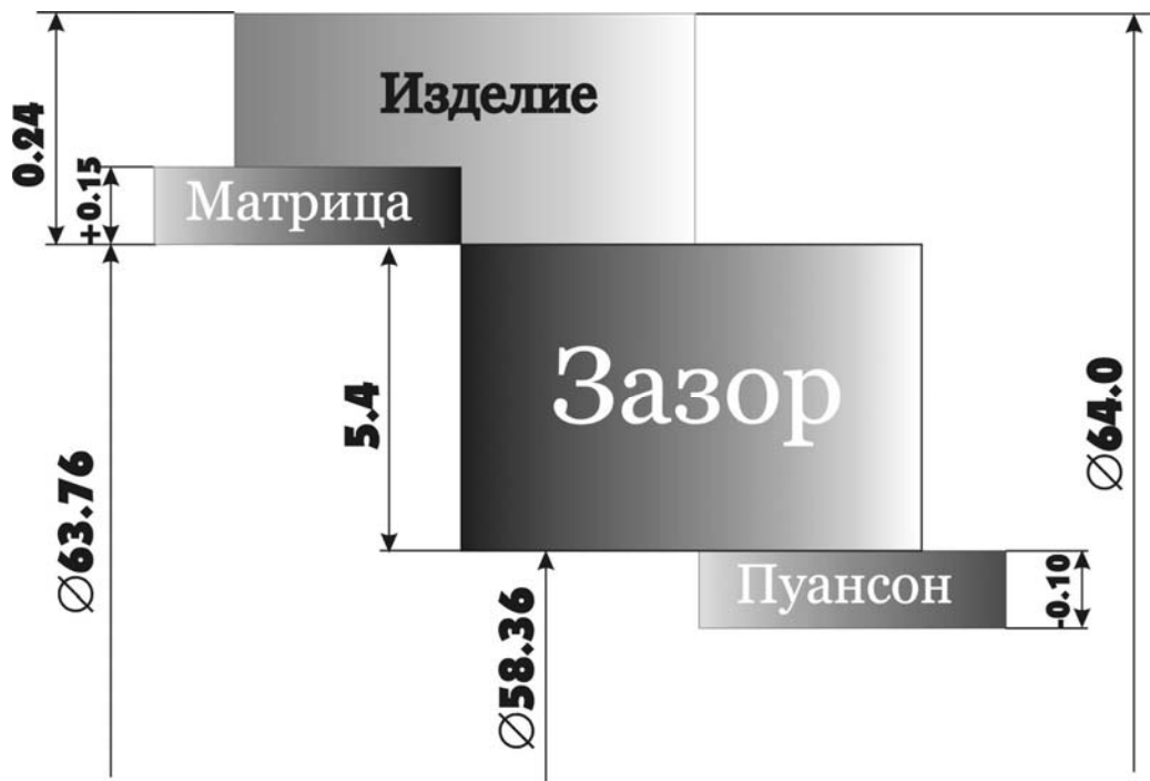
Рис. 3.7. Схема расположения допусков на исполнительные размеры инструмента при первой вытяжке
