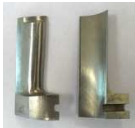
Рисунок 13.2 - Изделия, полученные методом взрывного прессования
