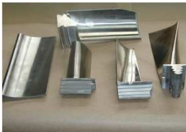
Рисунок 13.2 - Изделия, полученные методом взрывного прессования
