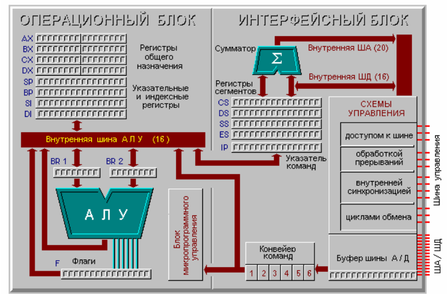
Рис. 1.2 Структура процессора Intel 8086
