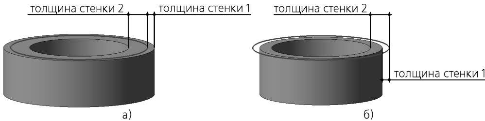
Рис. 24.14. Построение тонкой стенки в двух направлениях (на примере элемента выдавливания; сечение показано утолщенной линией): а) толщина стенки 1 и толщина стенки 2 положительные; б) толщина стенки 2 не изменилась, а толщина стенки 1 получила противоположный знак
