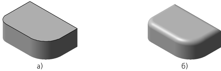
Рис. 31.1. Скругление: а) для построения скругления указана верхняя грань, б) результат построения скругления
