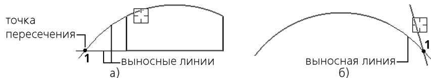
Рис. 113.54. Условное пересечение: а) для продолжений двух объектов; б) для объекта и продолжения другого объекта
