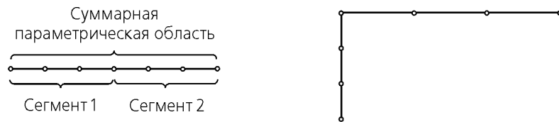
Рис. 46.3. Пример построения группы из 7 точек на ломаной: а) разбиение суммарной параметрической области ломаной на 6 равных участков, б) отображение точек разбиения на сегменты ломаной
