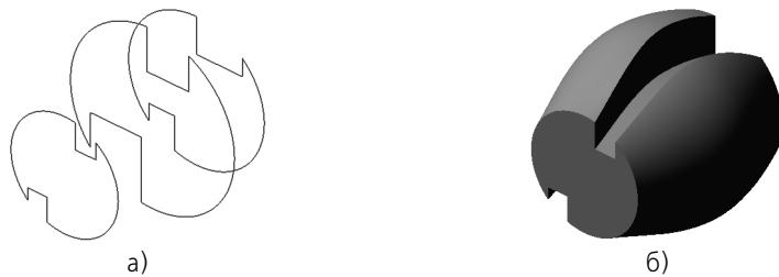
Рис. 27.3. Автоматическое соединение сечений
