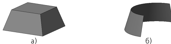
Рис. 48.3. Уклон боковых граней поверхности выдавливания: а) замкнутой, б) незамкнутой
