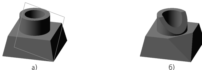
Рис. 31.9. Отсечение части детали плоскостью: а) исходное состояние детали (плоскость отсечения обозначена условно), б) результат выполнения операции отсечения
