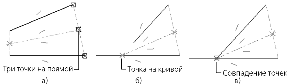
Рис. 192.1. Ограничения, наложенные на автоосевую при различном расположении отрезков
