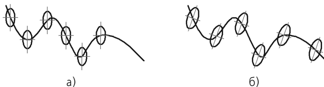
Рис. 118.2. Копирование объектов: а) с сохранением угла поворота и масштаба, б) с изменением угла поворота и масштаба
