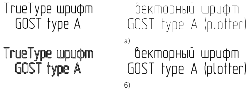
Рис. 119.5. Преобразование текстов в NURBS: а) исходные объекты — тексты, набранные TrueType-шрифтом и векторным шрифтом, б) результаты преобразования
