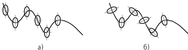
Рис. 118.5. Копирование эллипса вдоль сплайна: а) без доворота копий до нормали, б) с доворотом копий до нормали
