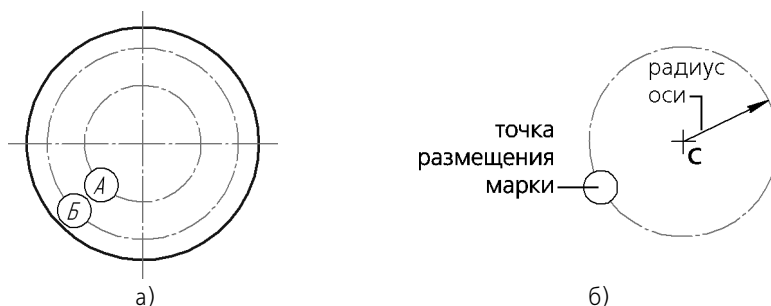
Рис. 114.30. Круговая координационная ось: а) пример использования, б) параметры оси
