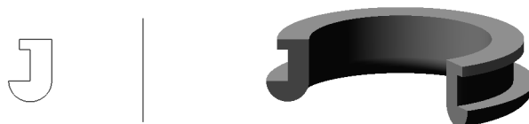
Рис. 25.1. Эскиз, ось и элемент, образованный операцией вращения
