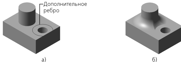
Рис. 48.32. Использование ребра, полученного разбиением грани: а) исходное состояние детали, б) результат построения скругления с сохранением кромки
