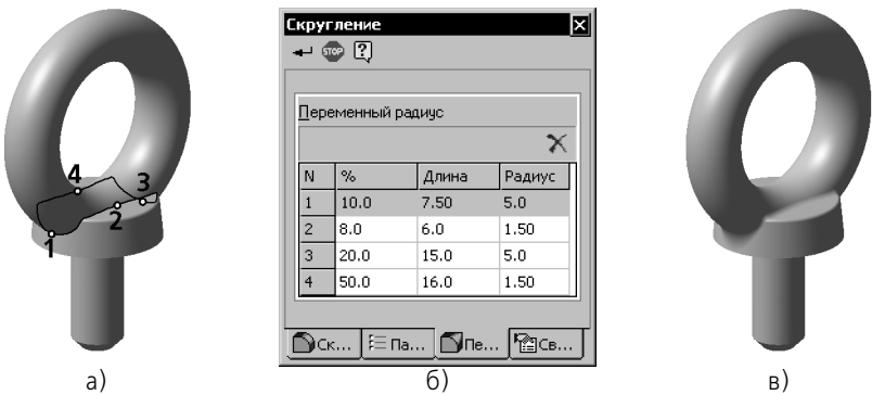
Рис. 31.3. Построение скругления с переменным радиусом: а) указание точек, б) задание параметров скругления, в) результат выполнения команды
