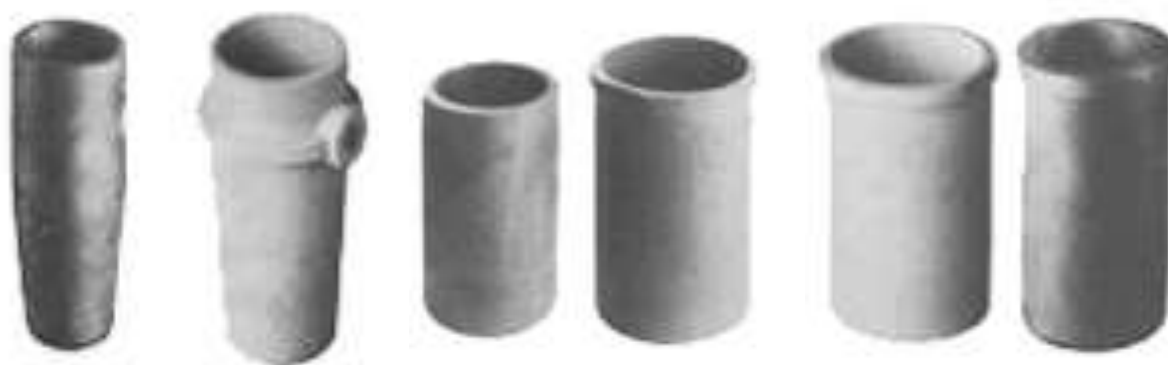
Рисунок 2.51 – Глиняные тигли для плавки ювелирных сплавов
