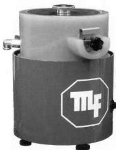
Рисунок 2.72 – Общий вид вибро-центробежной галтовки «ЕКО 5-R»
