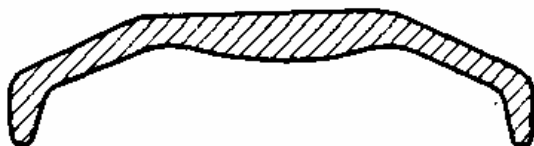
Рисунок 5.1 - Отливка рессорного балансира
