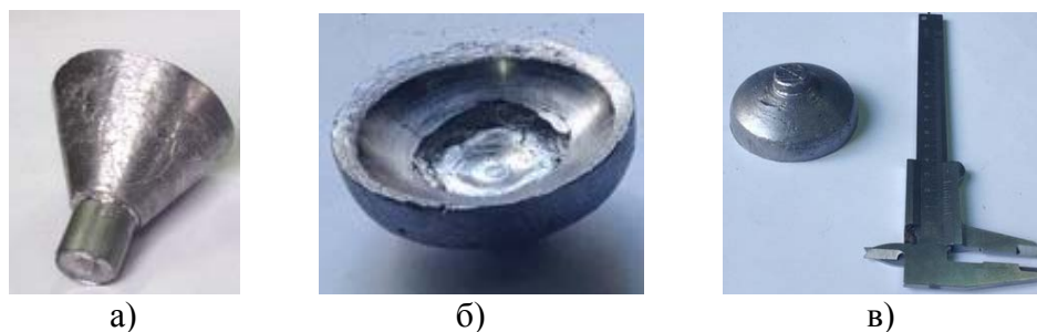
Рис. 3. Вихідна заготовка до роздачі сферичною плитою (а), поковка після роздачі (б) і вид зверху (в)
