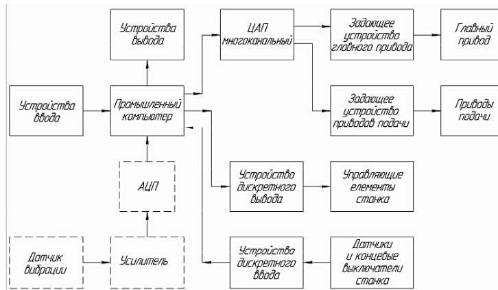
Рис. 2. Блок-схема устройства ЧПУ типа CNC с элементами системы диагностики режущего инструмента
