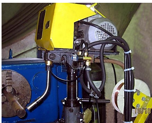
Рис. 3. Вибродуговая головка, оснащенная газозлектрической горелкой
