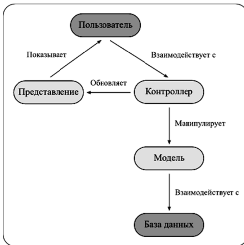
Рис. 1. Схематическая модель взаимодействия элементов MVC
