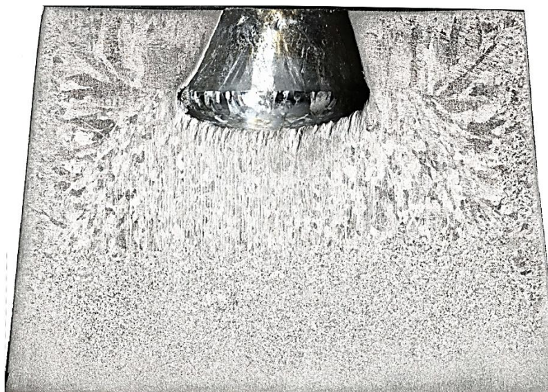
Рис. 5. Макростроение алюминиевого слитка
