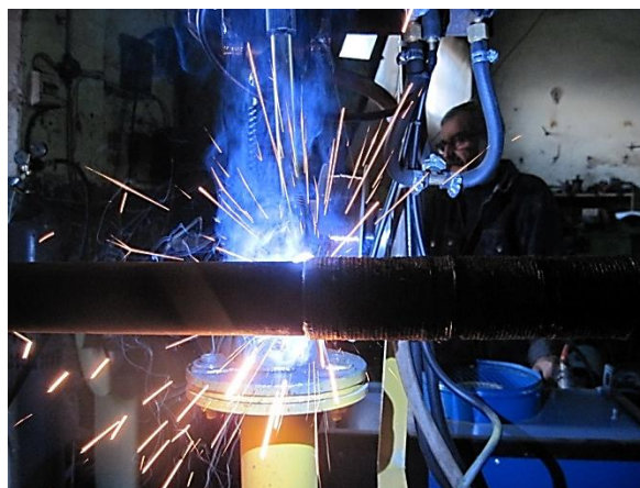
Рис. 4. Вибродуговая наплавка плунжера
