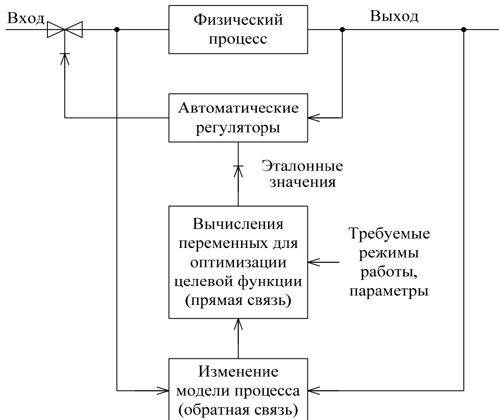
Рис. 1. Структурная схема с сочетанием прямой и обратной связи
