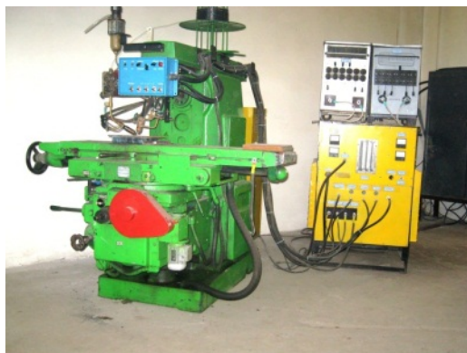
Рис. 1. Установка для наплавки пластин штампов на базе станка 6Р83
