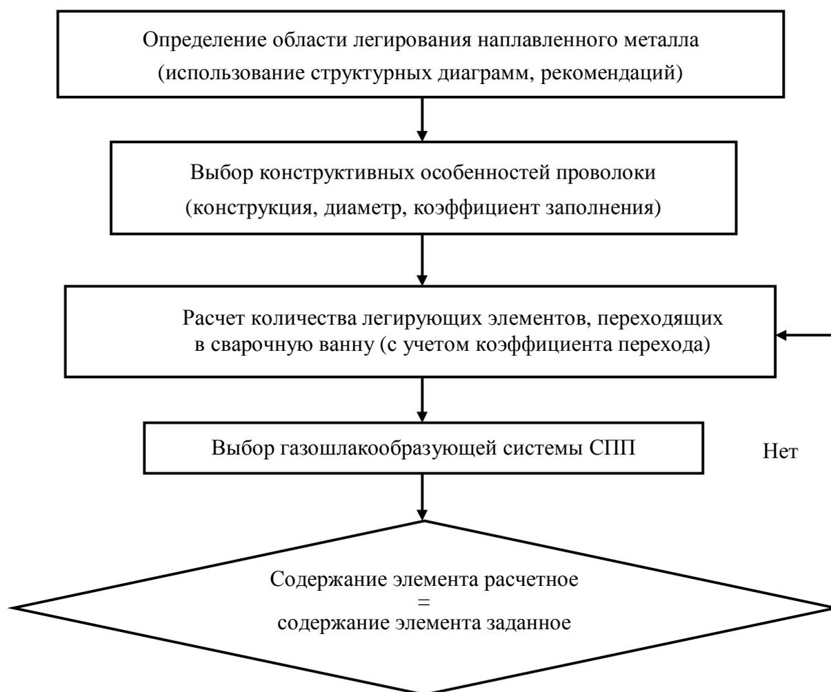
Рис. 3. Блок-схема методики расчета состава СПП
