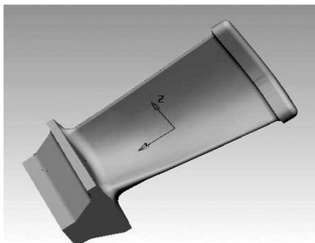
Рис. 3. Модель лопатки ГТД, построенная в программной среде Delcam
