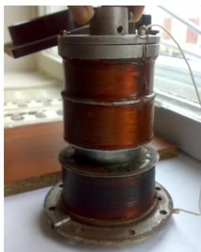
Рис. 3. Общий вид экспериментального ЛДПТ в собранном виде
