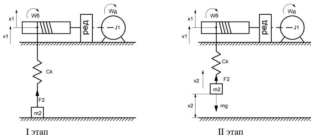
$J_1$  – момент инерции вала электродвигателя;  $W_д$  – скорость вращения вала;  $W_б$  – скорость вращения барабана;  $V_1$  – линейная скорость наматывания каната;  $X_1$  – линейное перемещение в точке приложения каната к барабану;  $C_k$  – жесткость каната;  $V_2$  – скорость движения груза;  $X_2$  – перемещение груза,  $m_2$  – масса груза;  $F_2$  – упругая сила в канате
