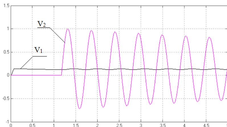
Рис. 7. График переходных процессов линейных скоростей каната и груза
