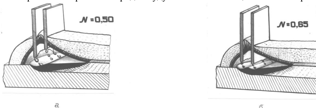
Рис. 1. Схема плавления первого и второго электродов и переноса капель при одинаковой токовой нагрузке ( N = 0,50 ) (а) и ее возрастания на втором электроде ( N = 0,65 ) (б)
