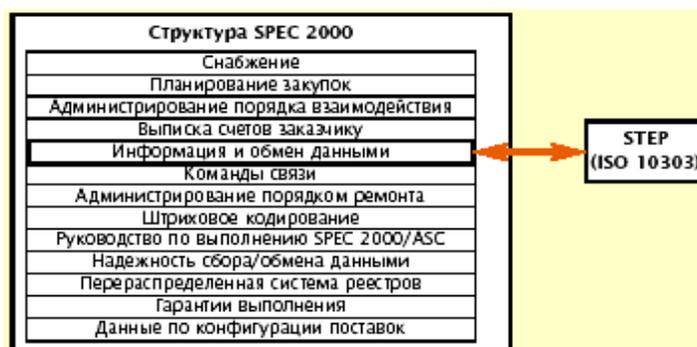
Рис. 4. Использование стандарта STEP в структуре SPEC 2000
