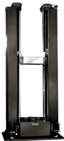
Рис. 2. Ударный стенд серии eXtreme Speed Series
