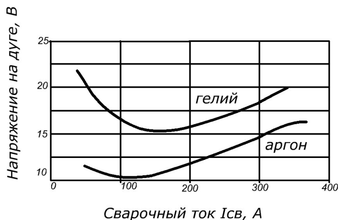
Рисунок 2 – Статические характеристики сварочной дуги
