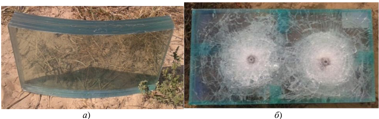
Рисунок 2 – Гнутий композитний скло-полімерний блок ТОВ «Альтіс-гласс»: а – у вихідному стані; б – випробуваний за 4 класом стійкості за ДСТУ4546:2006
