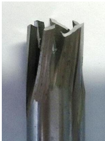
Рисунок 1 – Кільцеве свердло для обробки вуглепластику
