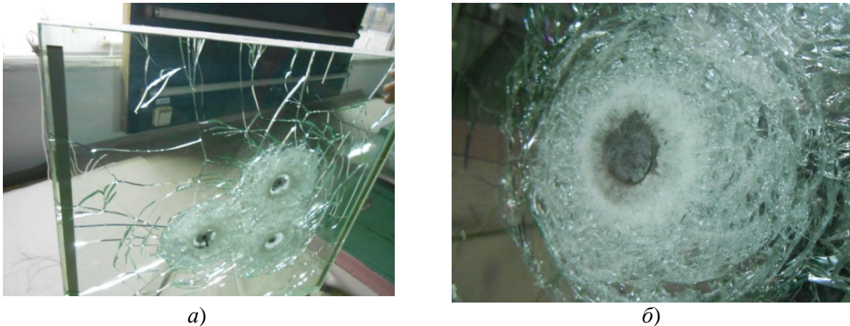
Рисунок 1 – Електрообігрівний (з лицьової та тильної сторони) захисний склоблок виробництва ПАТ «Спецтехскло - А», випробуваний за 3 класом стійкості за ДСТУ4546:2006: а) загальний вид блоку після випробувань; б) характер руйнування при ударному навантаженні ударником 7,62мм
