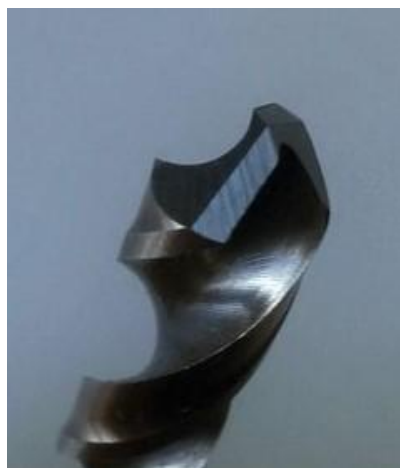
Рисунок 2 – Спіральне свердло для обробки вуглепластику
