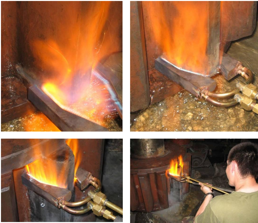
Рисунок 5 – Закалка зуба m = 50 горелкой ГЗУ-6-КМ50.
