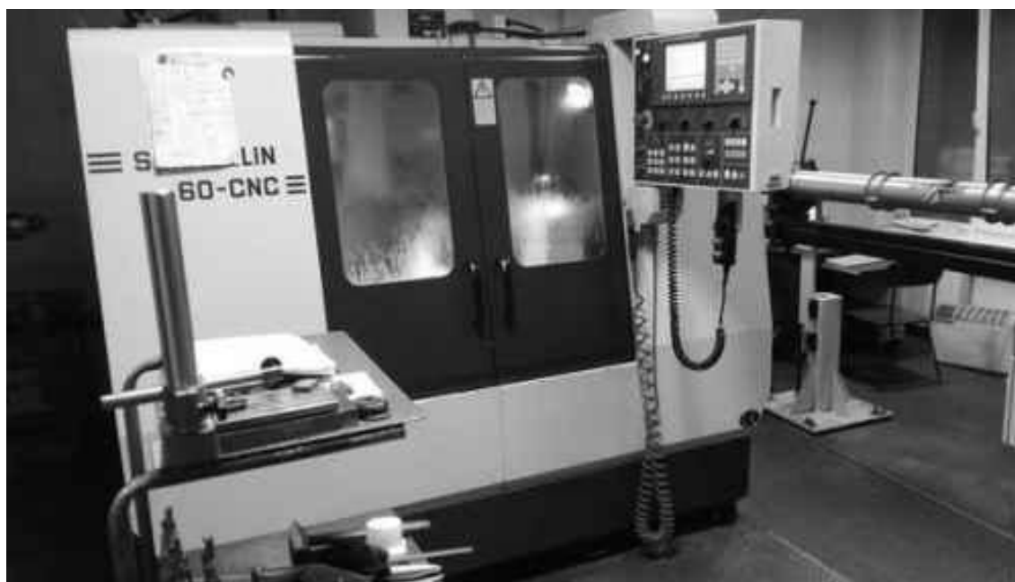
Рисунок 2 – Фрезерний верстат з ЧПК моделі "Schaublin 60 CNC"
