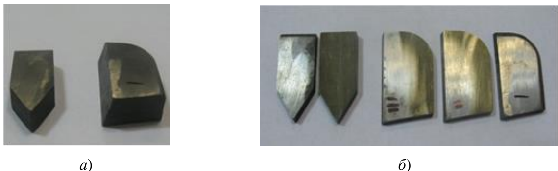
Рис. 3 – Напайні різальні пластини із сплаву ВК3 та ВК8 (а); зразки з пластин ВК3 та ВК8, виготовлені шляхом ерозійної різки (б)
