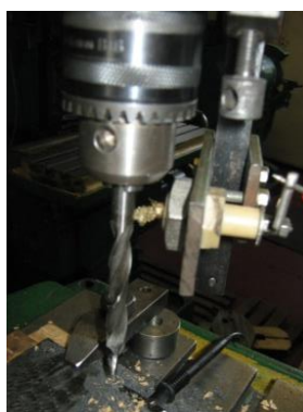
Рис. 7 – Зображення пристосування для вимірювання температури інструменту
