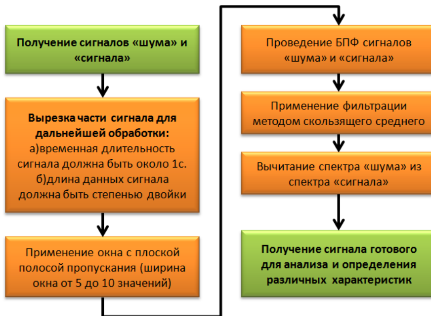
Рис. 12 – Алгоритм (методика) цифровой обработки вибрационного сигнала
