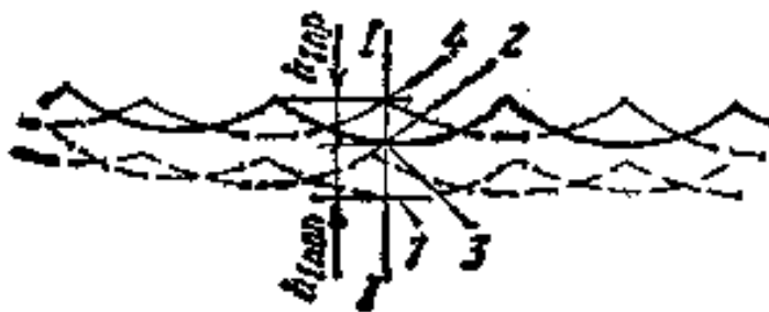
Рис. 5 – Исходная схема для определения составляющей профиля шероховатости h_1 в поперечном сечении I – I:
