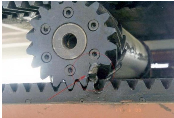
Рис. 6 – Излом зубчатого зацепления в следствие повышенных нагрузок и несоответствия твердых смазок
