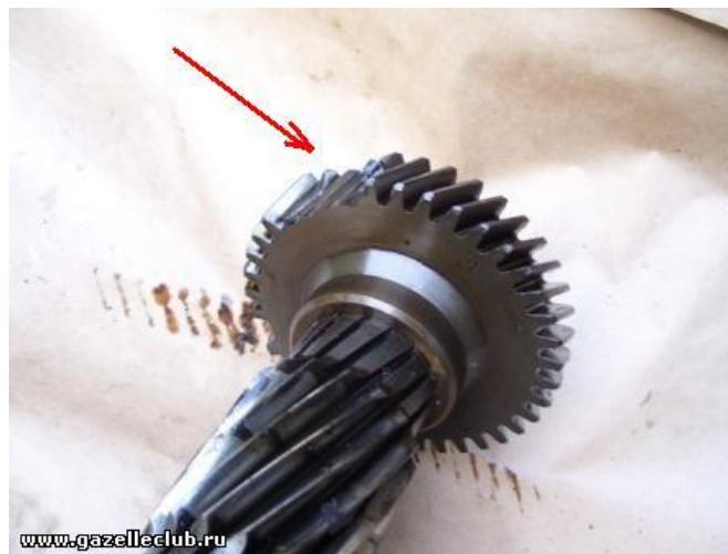
Рис. 5 – Разрушение зубчатого колеса в следствие повышенных нагрузок и несоответствие системы и подачи смазки
