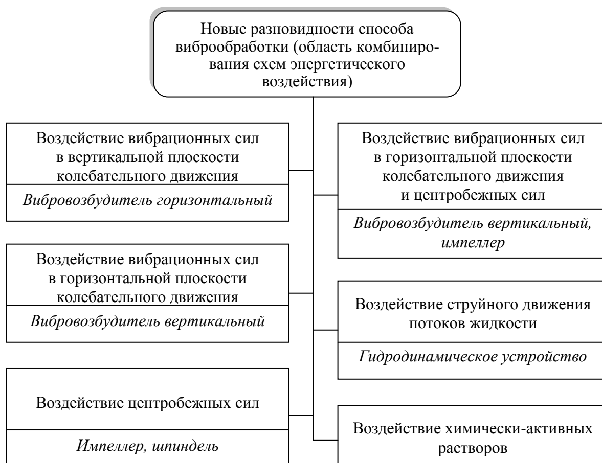
Рис. 1. Вариативная схема комбинирования энергетических воздействий в новых разновидностях метода виброобработки
