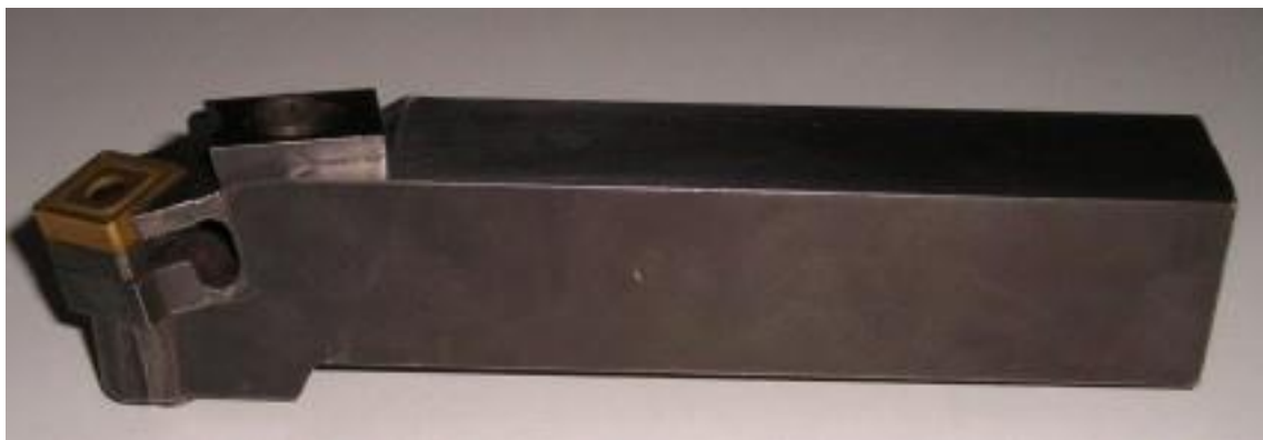
Рис.1 – Резец с креплением поворотной рабочей части штифтом и клином
