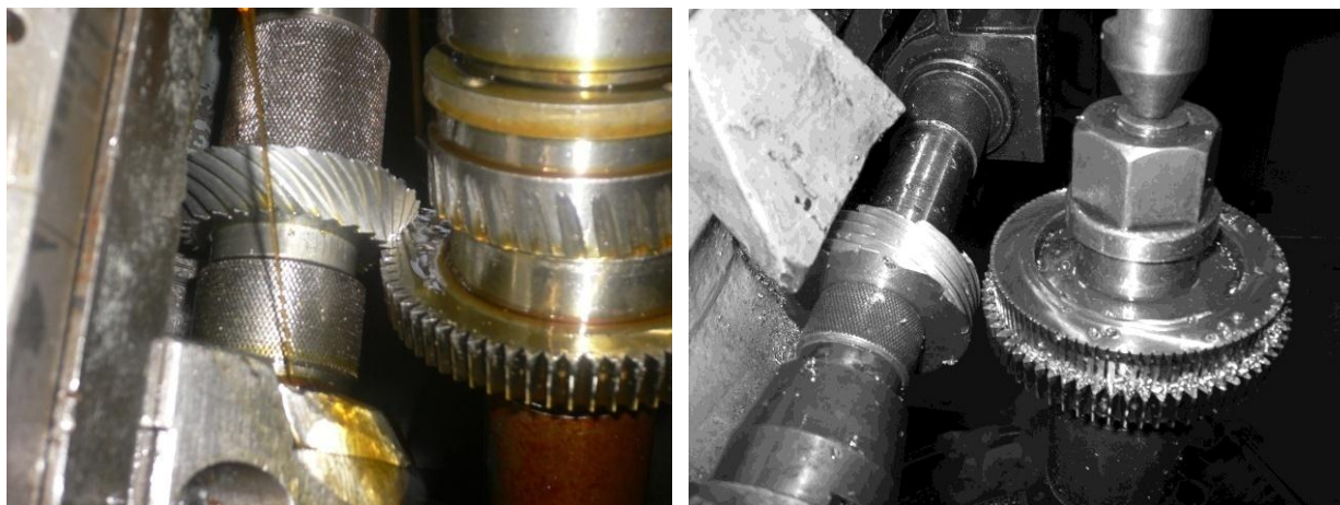
Рис. 2 – Виготовлення гіперболоїдного накатника
