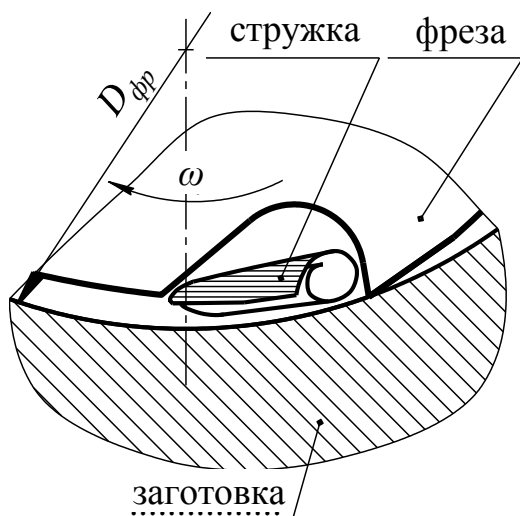
Рис. 2 – Схема взаимодействия элемента стружки с фрезой и заготовкой при отсутствии пластической деформации
