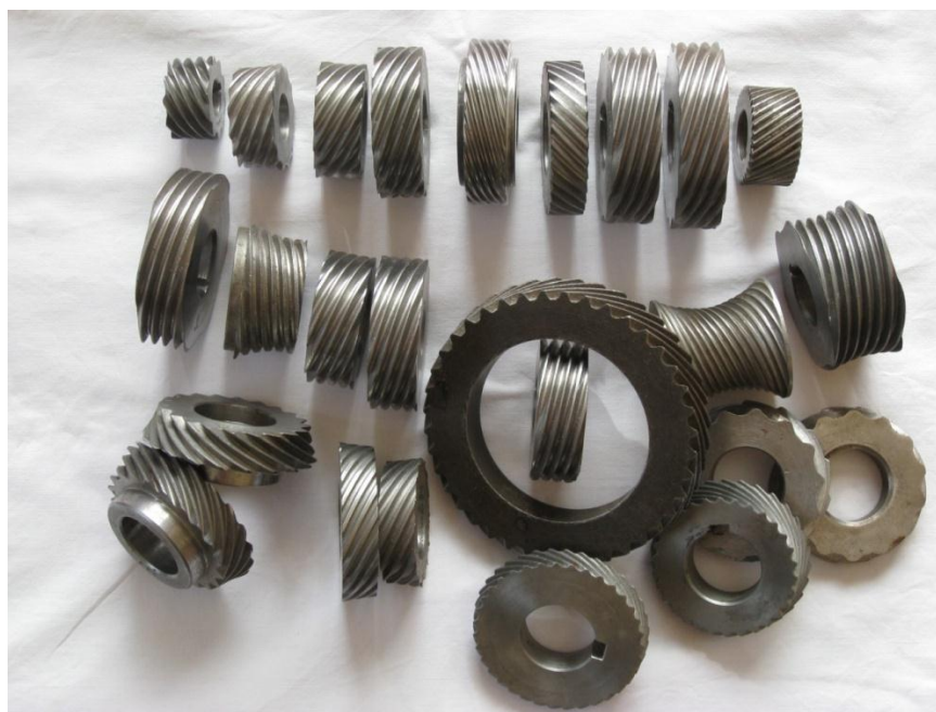
Рис. 3 – Накатний інструмент різноманітної геометрії.
