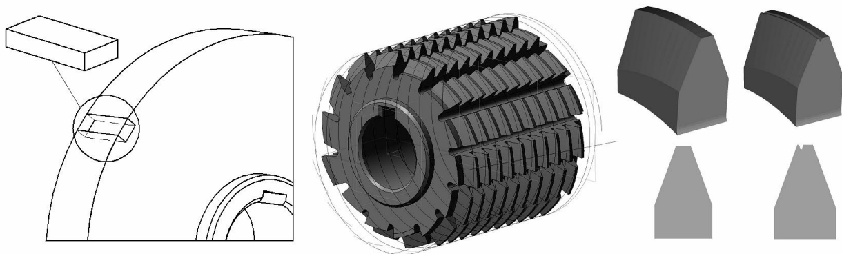
Рис. 9 – 3D моделі заготовки та елементи різального інструменту, підготовлені для використання в системі DEFORM
