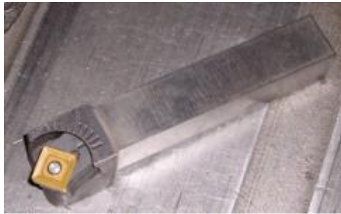
Рис.2 – Резец с креплением поворотной рабочей части штифтом
