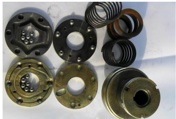
Рис. 3 – Кулькові низькочастотні запобіжні муфти:
