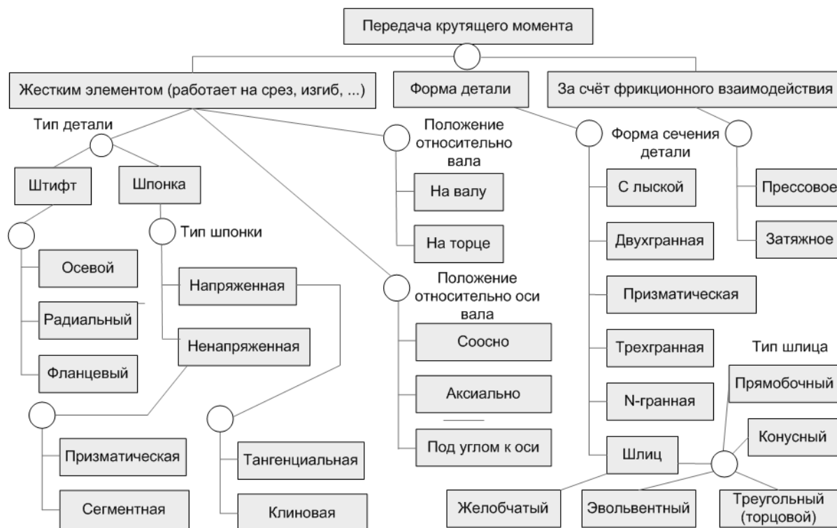
Рисунок 2 – Классификация конструктивных решений для передачи крутящего момента на валу
