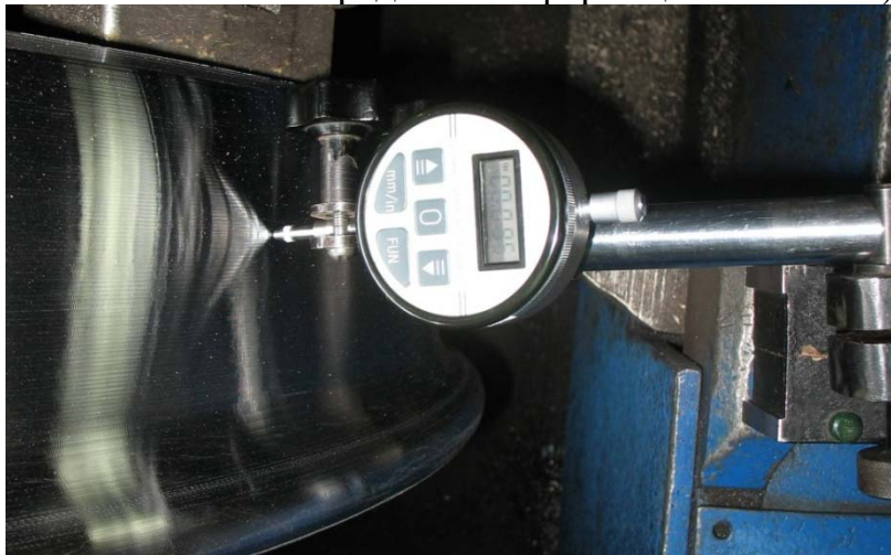
Рисунок 2 – Вимірювальна система виконана на основі цифрового контактної індикатора
