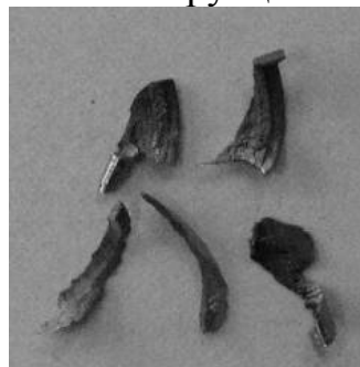
Рисунок 6 – Найбільш характерні форми стружки при зубофрезеруванні стандартною фрезою та фрезою запропонованої конструкції
