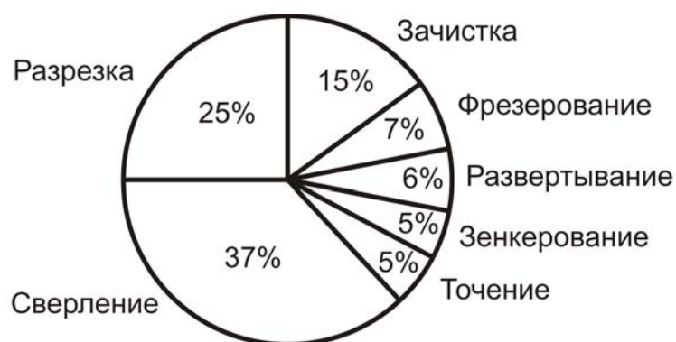
Рисунок 1 – Структура механической обработки полимерных композитов
