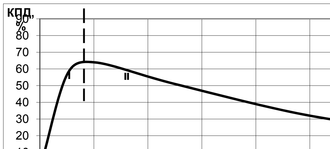
Рисунок 7 – Изменение КПД двигателя, работающего на процессе полиморфного превращения \beta -олова при переходе в \gamma -олово в зависимости от удельных давлений I – изученная область зависимости; II – предполагаемая (расчетная) область зависимости
