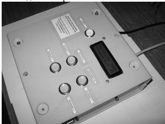
Рисунок 4 – Внешний вид устройства управления формированием импульсных токов
