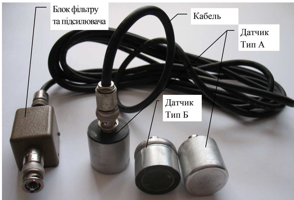
Рисунок 6 – Комплект датчиків для вимірювання сигналів АЕ в зоні різання
