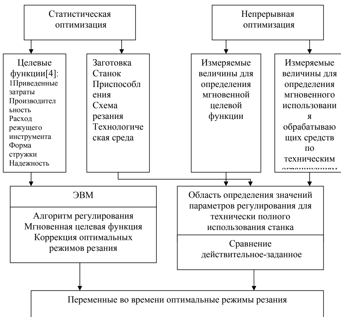
Рисунок 3 – Взаимосвязь между статистической и непрерывной оптимизациями для систем оптимального регулирования
