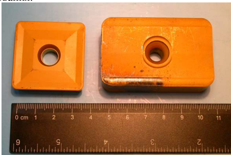
Рисунок 1 – Специальные многогранные пластины для черновой и получистовой обработки
