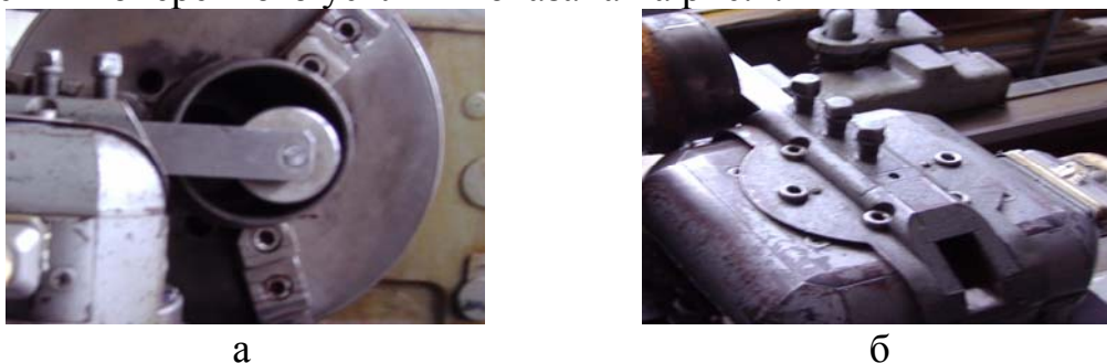
Рисунок 1 – Схема обкатки заготовки с использованием универсального динамометра УДМ-600
