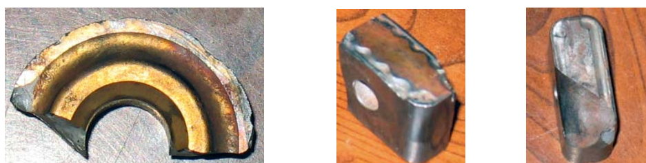
Рисунок 3 – Поломка режущих пластин при обработке зоны ползуна
