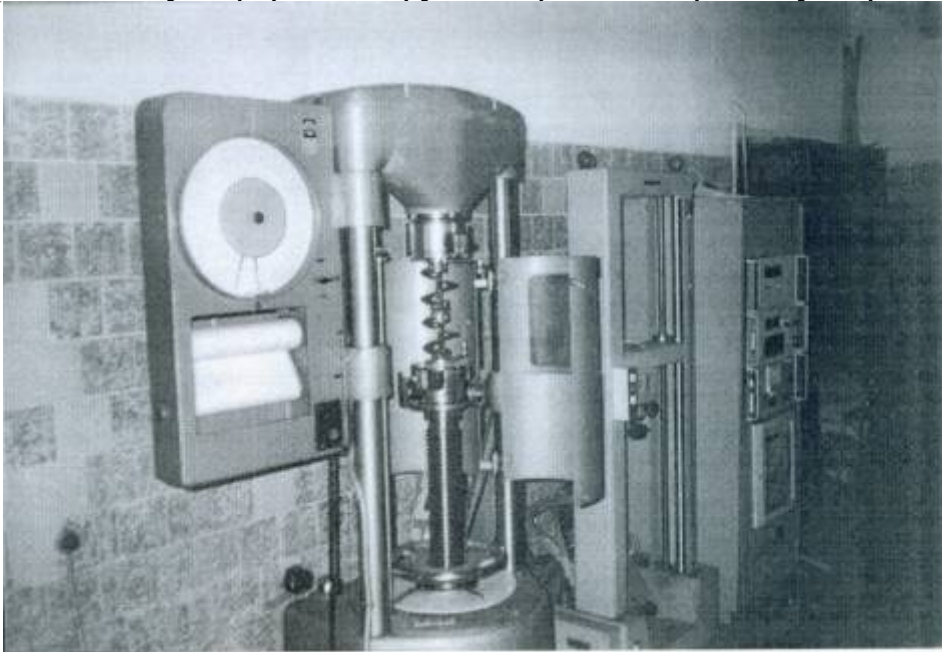
Рисунок 1 – Дослідження крутильної жорсткості робочих органів ГТТМ у зібраному вигляді
