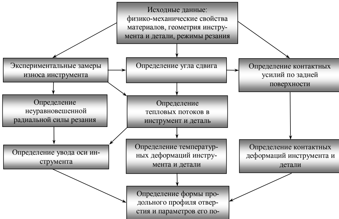
Рисунок 2– Блок-схема алгоритма прогнозирования продольного профиля отверстия с учетом температурных и упругих деформаций
