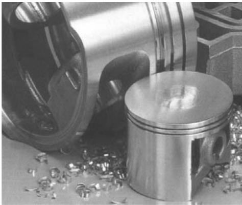
Рисунок 1 – Поршни ДВС, обработанные инструментом с ПКА
