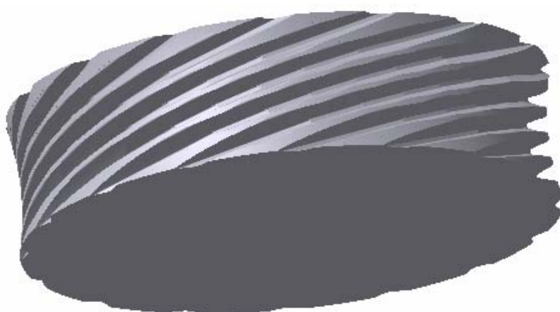
Рисунок 4 – Заготовка шестнадцатизаходной фрезы
