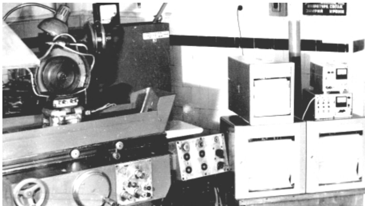
Рисунок 1 – Загальний вигляд установки для фрикційно-зміцнювального оброблення плоских поверхонь деталей
