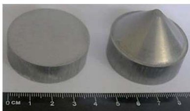
Рис. 1. Зовнішній вигляд заготовок під гаряче штампування за різними технологічними схемами
