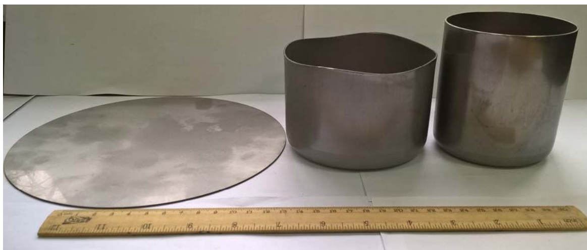
Рис. 14. Технологическая цепь изготовления детали: лева-направо: исходная заготовка, полуфабрикат после первой вытяжки, готовая деталь после подрезки торца
