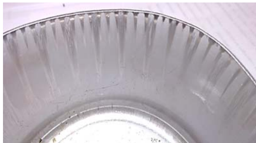
Рис. 12. Гофрообразование на внутренней стенке полуфабриката
