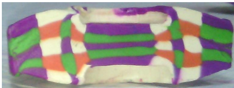
Рис. 2. Заготовка после сжатия центральными пуансонами
