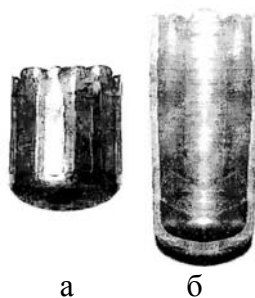
Рис. 6. Изделие после вытяжки (а) и протяжки (б)
