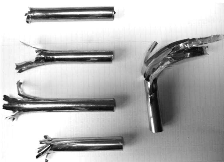
Рис. 1. «Состыкованные» и прокатанные торцы труб
