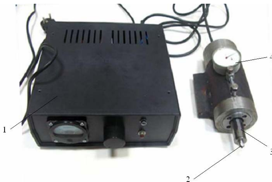
Рис. 1. Установка для выглаживания с дополнительным ультразвуковым нагружением
