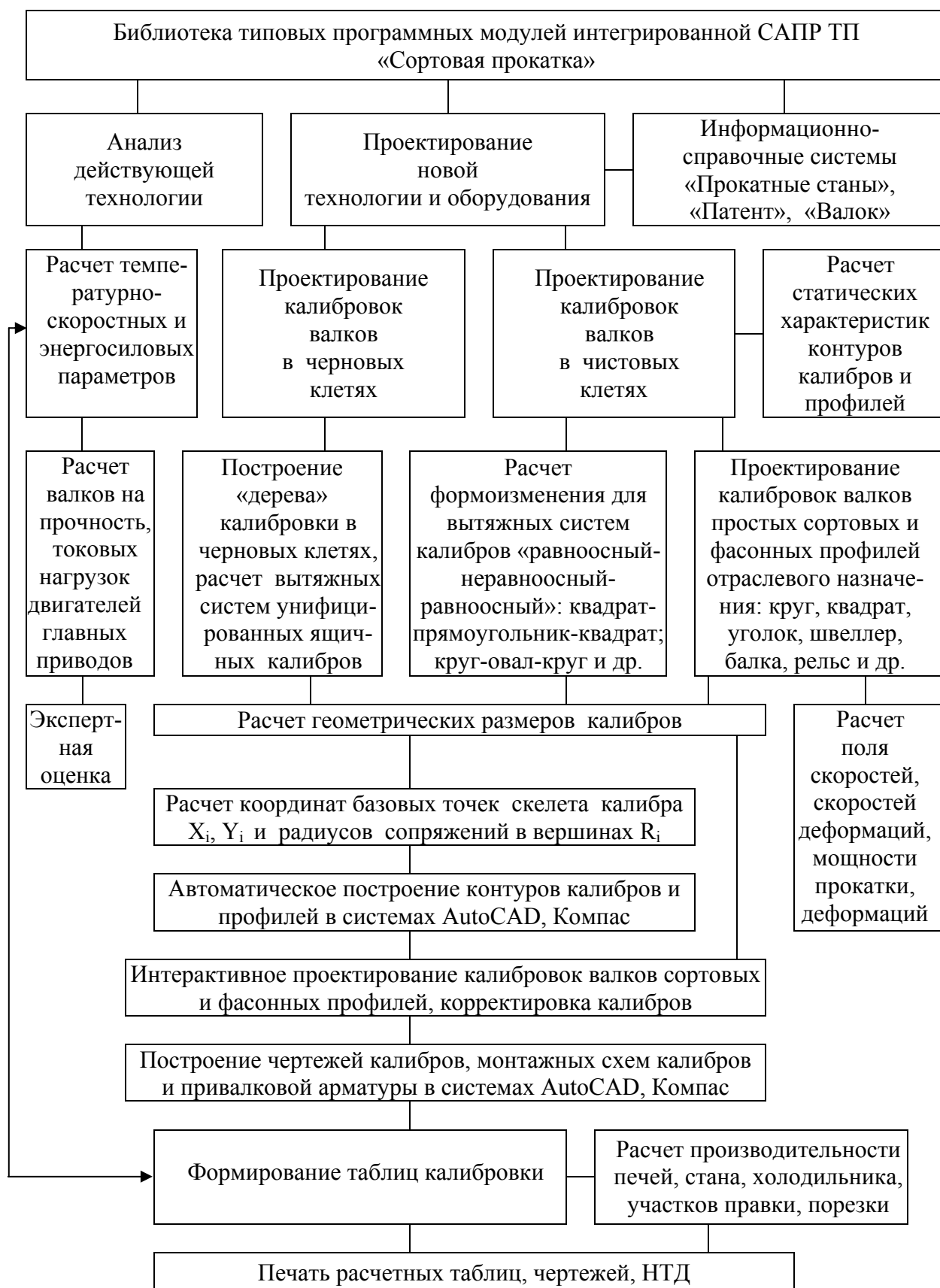
Рис. 1. Библиотека типовых программных модулей интегрированной САПР ТП «Сортовая прокатка»
