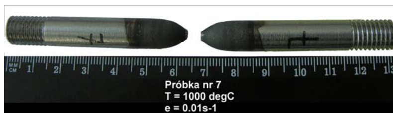
Рис. 1. Образец после разрыва в опытах по определению критической деформации
