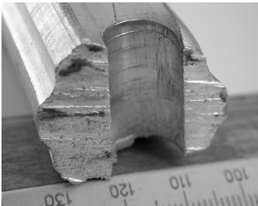
Рис. 2. Заготовка из дюралюминиевого сплава со следами дробной деформации, проштампанная за 11 ходов пресса
