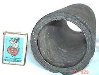
Рис. 4. Биметаллическая центробежнолитая чугунная отливка
