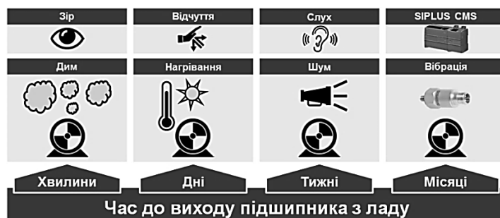
Рис. 4. Можливості контролю стану підшипників за допомогою SIPLUS CMS
