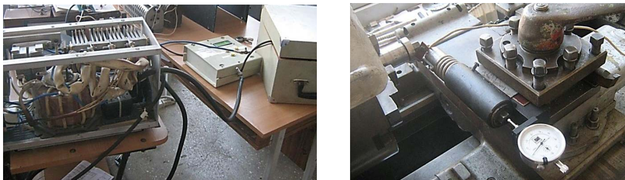
Рис. 1. Оснащення для вигладжування: а – генератор імпульсів струму прямокутної форми; б – вигладжувач
