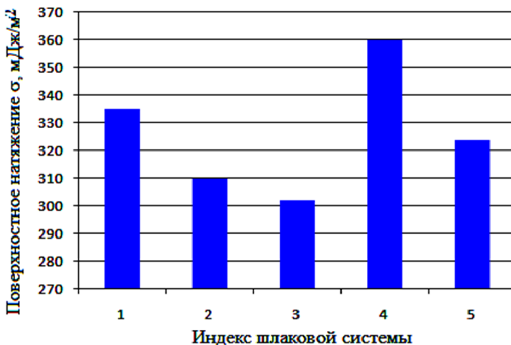
Рис. 2. Диаграмма зависимости поверхностного натяжения шлака от индекса порошковой проволоки (выбранной шлаковой системы)
