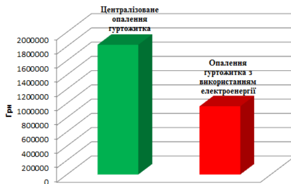
Рис. 5. Порівняння витрат на опалення гуртожитка ДДМА з використанням централізованого опалення та опалення електроенергією у найбільш холодний період
