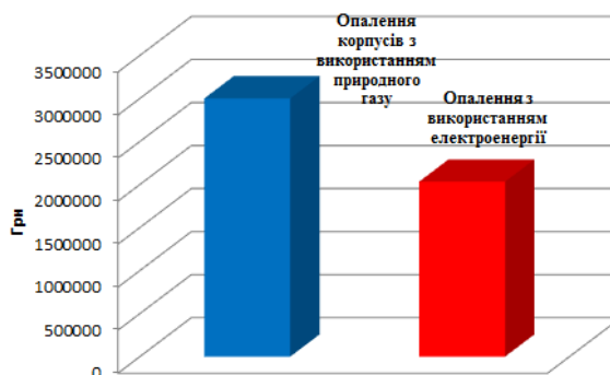
Рис. 11. Діаграма витрат на опалення корпусів природним газом та у перерахунку в еквіваленті газу на 1 Квт/год електроенергії у найбільш холодний період
