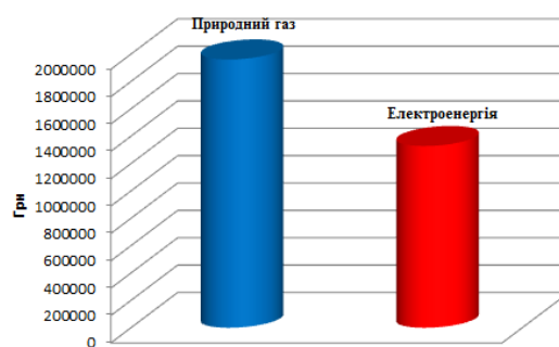
Рис. 3. Діаграма витрат на опалення корпусів природним газом та у перерахунку в еквіваленті газу на 1 кВт/год електроенергії
