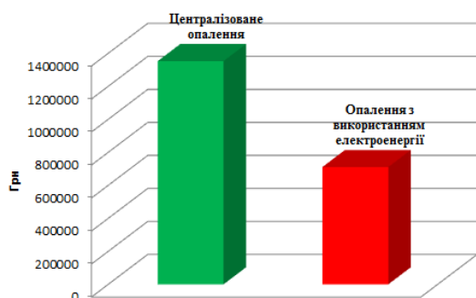
Рис. 2. Діаграма середніх витрат на опалення гуртожитку ДДМА за тарифами 2019 року на всі види опалення
