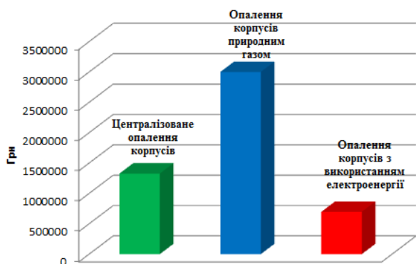
Рис. 4. Порівняння витрат на опалення з використанням різних способів опалення у найбільш холодний період
