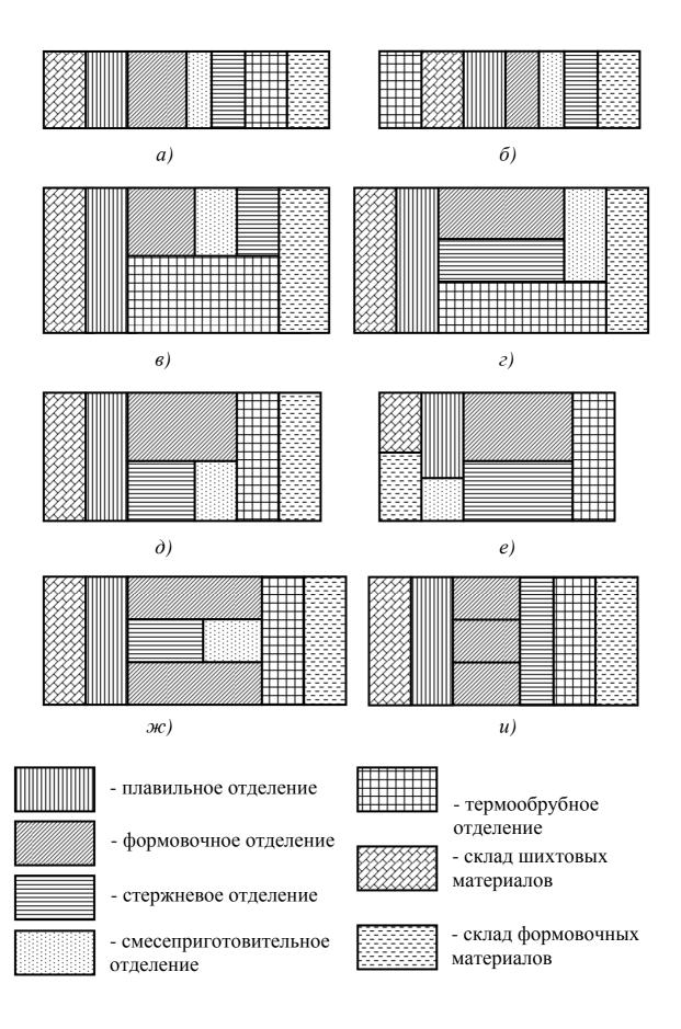
Рисунок 6.1 – Схемы рекомендуемых компоновочных решений чугунои сталелитейных цехов различного назначения
