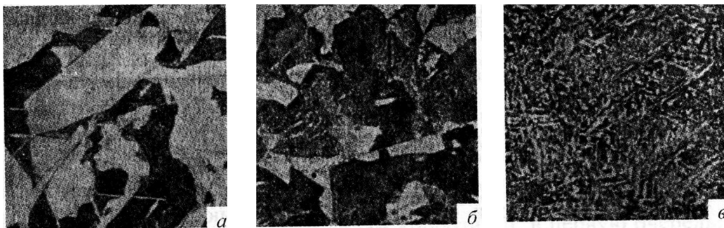
а – хромиста сталь (2,5% Cr); б – та ж сталь з 3% Ni; в – з 5% Ni Рисунок 2.3 – Вплив нікелю на поліпшення структури хромової сталі при вторинній кристалізації металу в виливках з товщиною стінки 80 мм
