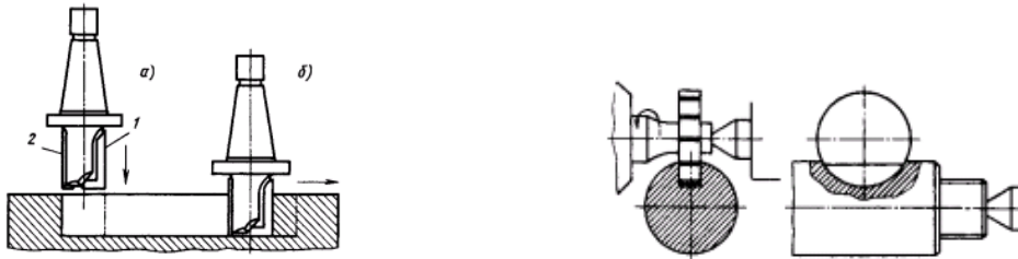
Рисунок 2.12 – Обробка шпонкових пазів свердлопазовою фрезою Walter (ФРН) та шпонкового паза під сегментну шпонку дисковою фрезою
