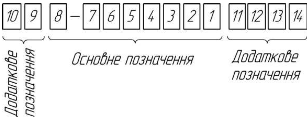
Рисунок 15.6 – Основні та додаткові позначення підшипників кочення
