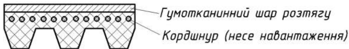
Рисунок 10.7 – Переріз поліклинового пасу
