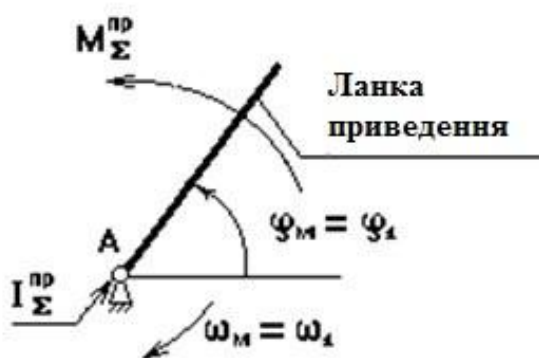
Рисунок 7.1 – Динамічна модель механізму з обертовою вхідною ланкою
