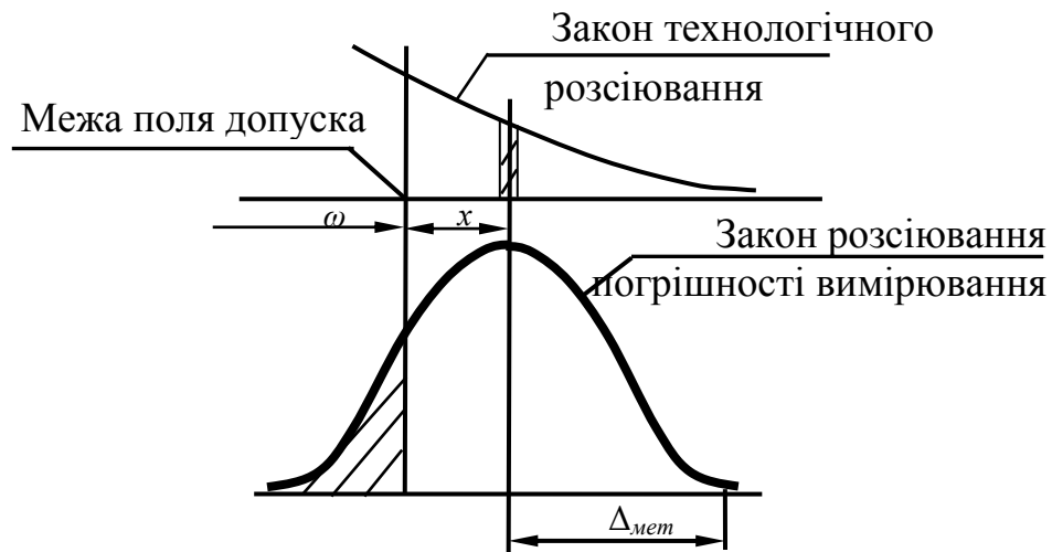
Рисунок 26 – Взаємодія похибки вимірювання і технологічного розсіювання розмірів
