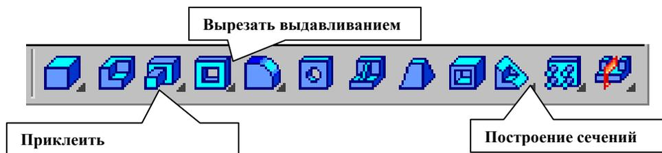
Рис.72 Компактная панель **Редактирование детали**
