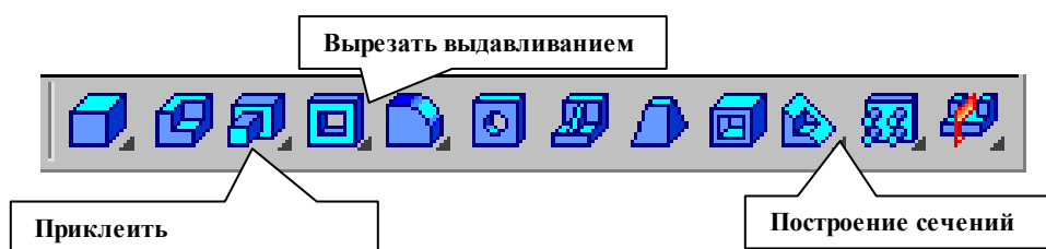
Рис.72 Компактная панель Редактирование детали
