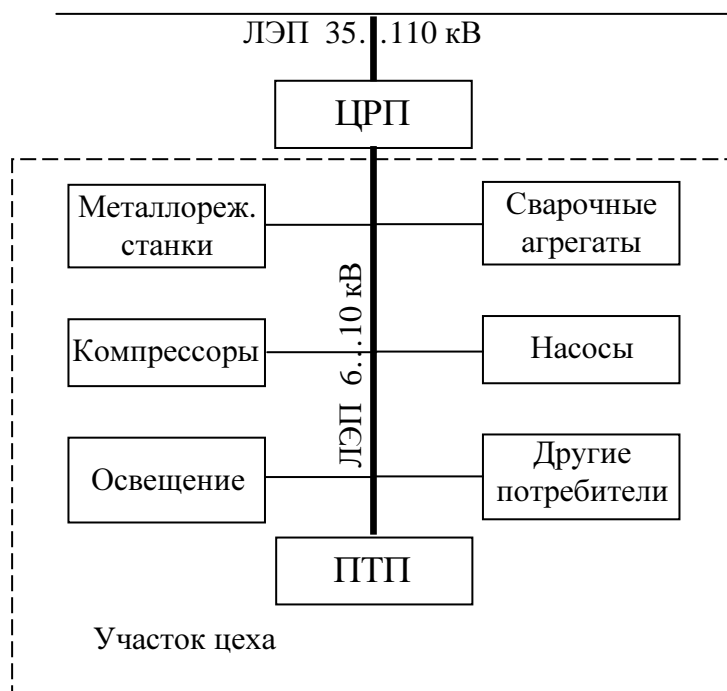
Рисунок 1 – План расположения электропотребителей ЦРП
