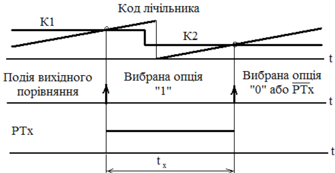
Рисунок 2.9 – Формування часового інтервалу з використанням апаратних засобів каналу вихідного порівняння.
