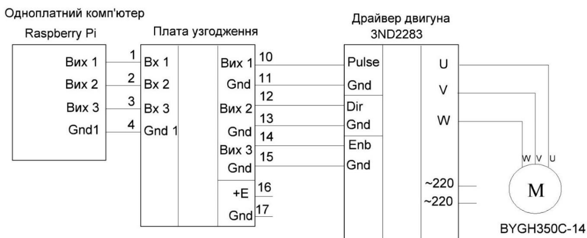
Рис. 1 Структура управління кроковим двигуном
