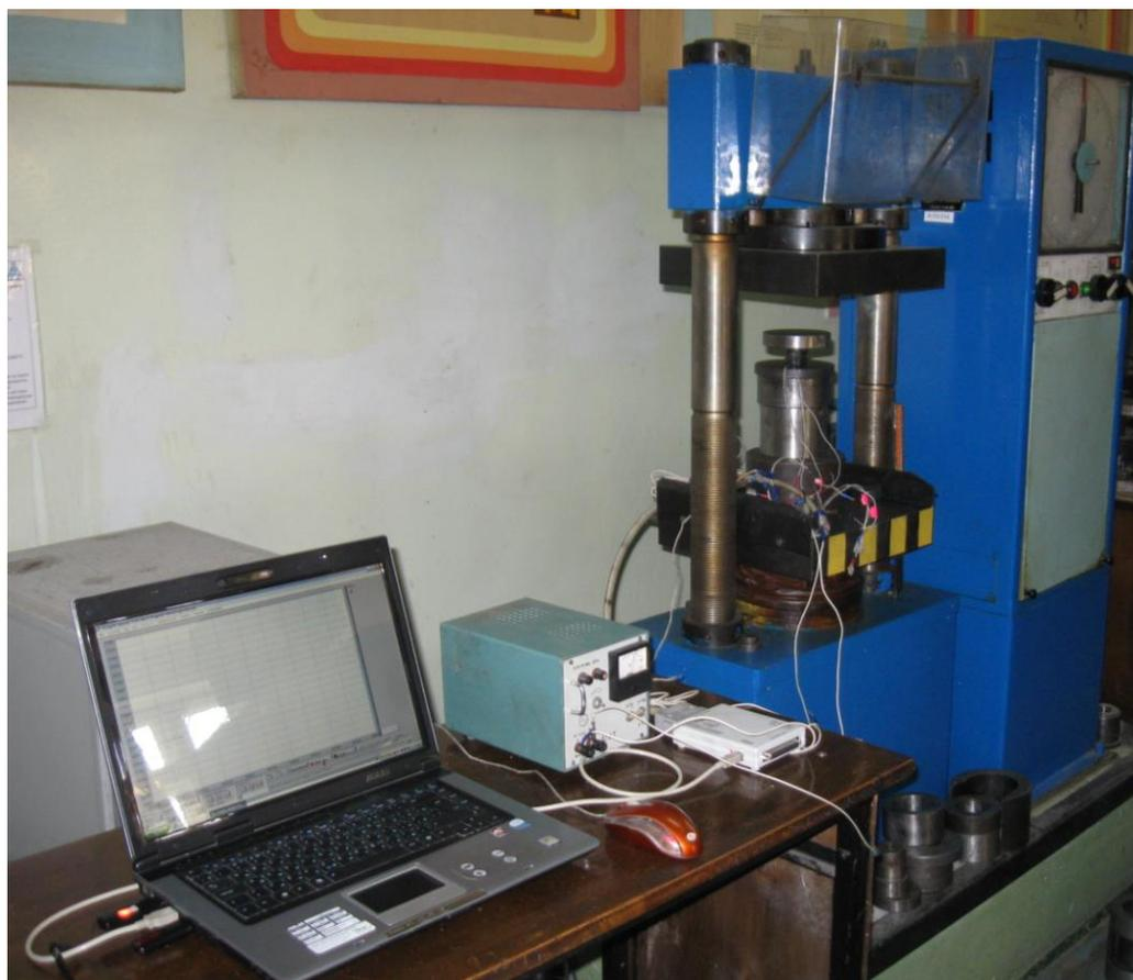
Рисунок 2.13 - Схема подключения тензорезисторов АЦП и тензометрической аппаратуры к ПК
