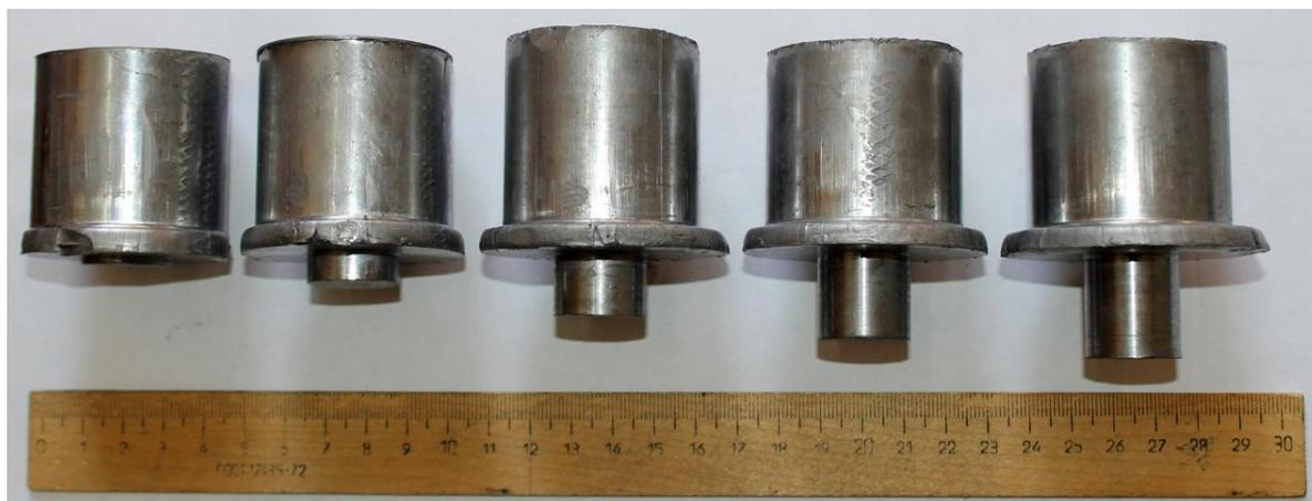
Рисунок 4.1 – Поэтапное формоизменение заготовки из свинца С1
