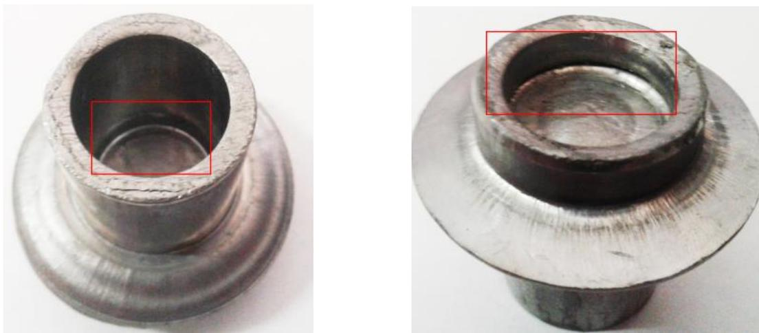
Рисунок 4.17 – Дефект в виде прострелов при трехстороннем выдавливании
