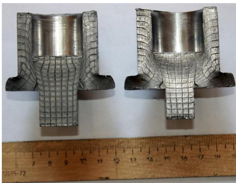
Рисунок 4.14 – Сравнение деформированного состояния у деталей с разным диаметром отростка
