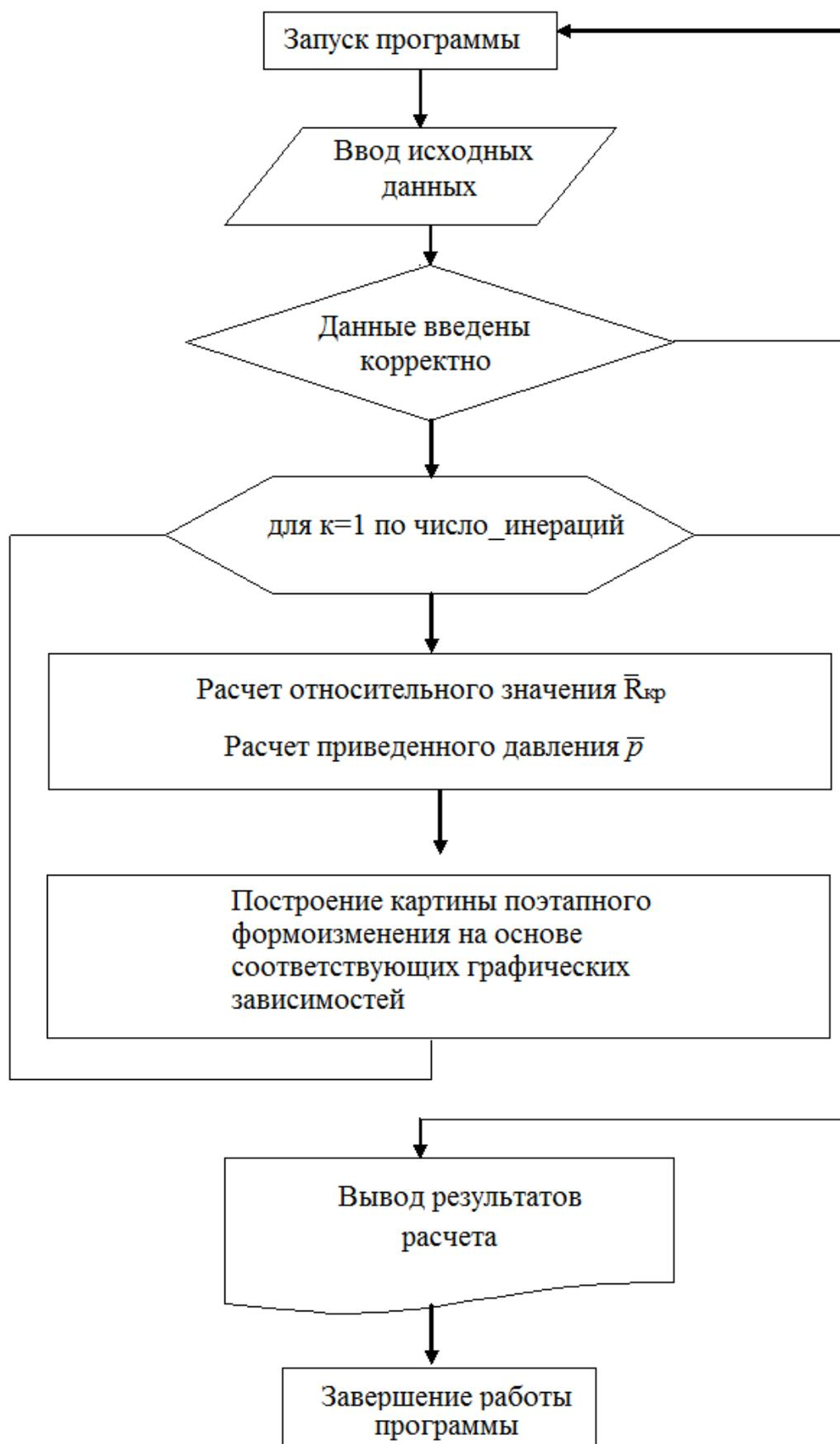
Рисунок 5.2 – Последовательность действий при работе программы
