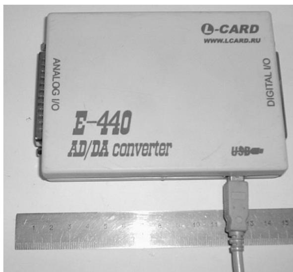
Рисунок 2.11 - Аналогово-цифровой преобразователь (АЦП) L-Card E-440
