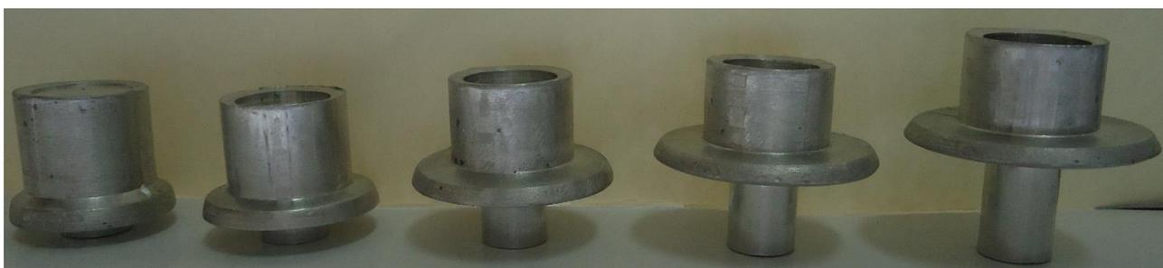
Рисунок 4.2 – Поэтапное формоизменение заготовки из алюминиевого сплава АД1
