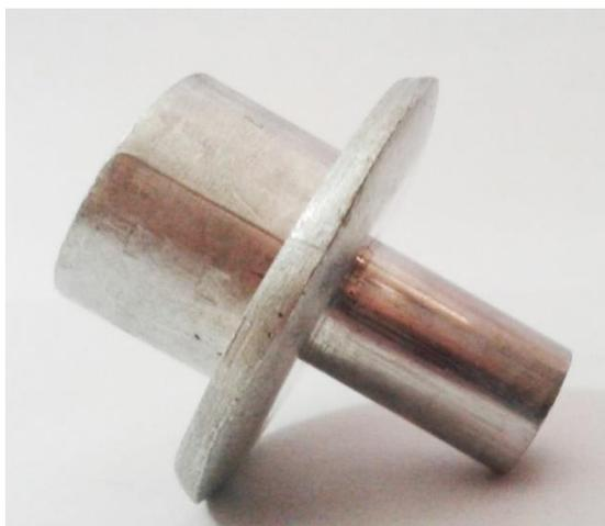
Рисунок 4.15 – Отклонение формы фланца, дефект «седла»
