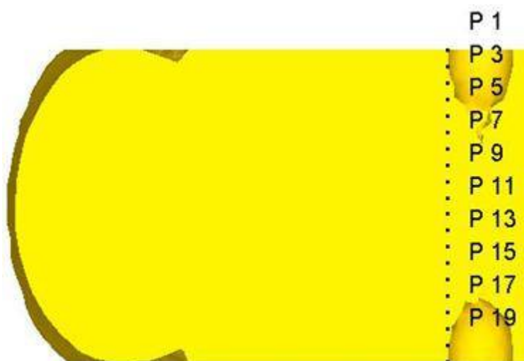
Рисунок 2.8 – Расстановка контрольных точек для определения интенсивности логарифмических деформаций в осевой зоне заготовки
