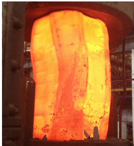
Рисунок 5.4 – Потеря устойчивости при осадке заготовок с несимметричным профилем
