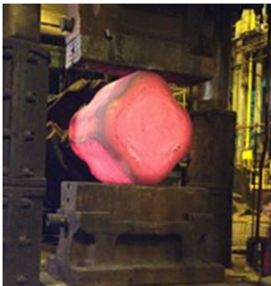
Рисунок 5.18 – Ковка четырёхлучевой заготовки плоскими бойками
