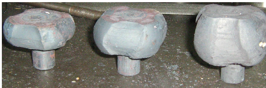
Рисунок 4.13 – Заготовки с соотношением H/D = 1,5; 2,0; 2,5 после профилирования бойками с углом 120^\circ и их последующей осадки
