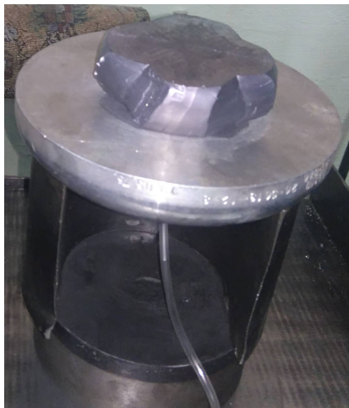
Рисунок 4.9 – Исследование закрытия осевого дефекта в процессе профилирования и осадки четырёхлучевых заготовок
