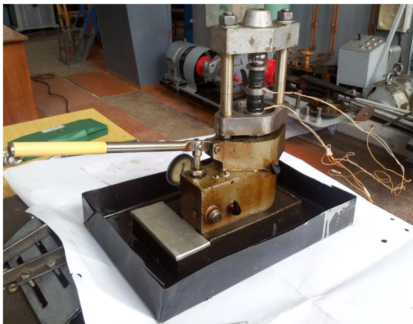
Рисунок 6.11 – Тарировка кольцевых месдоз на гидравлическом прессе
