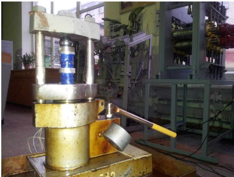
Рисунок 2.6– Схема тарировки кольцевых месдоз на гидравлическом прессе
