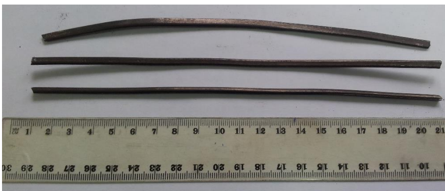
Рисунок 6.12 – Образцы порошковых проволок до эксперимента (а) и образцы плющенных лент после прокатки на стане (б)
