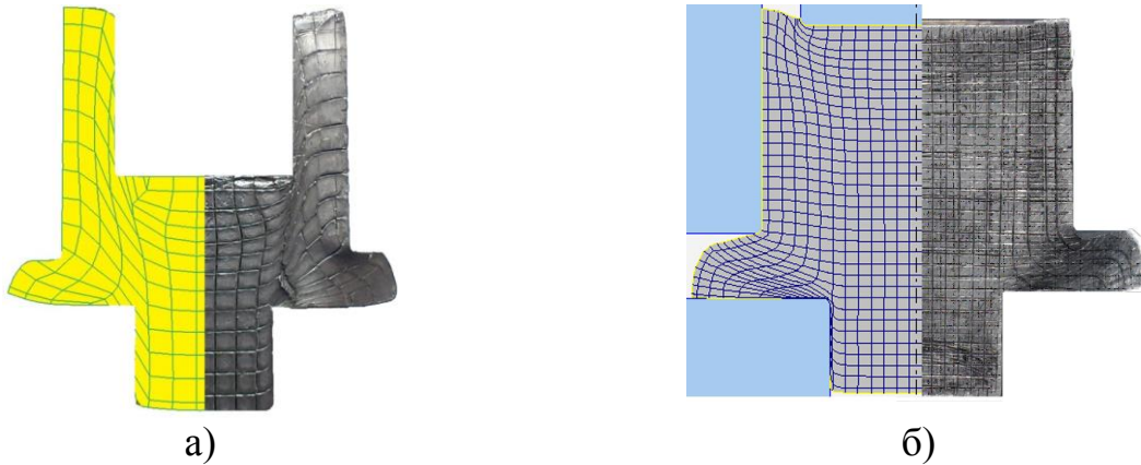
Рисунок 12 – Порівняння формозміни та розташування осередків деформації, отриманих МСЕ та експериментальними дослідженнями для матеріалів С1 (а) та АД1 (б)
