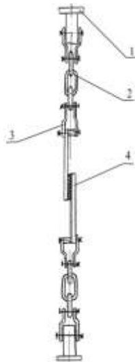
Рис. 2 – Схема закріплення зразків: 1 – захоплювачі, 2 – ланцюг, 3 – кріпильні планки, 4 – зразок.
