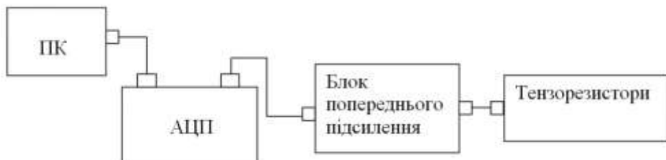
Рис. 7 – Принципова схема вимірювання сили переміщення супорта верстата
