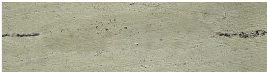
Рисунок 4.9 – Мікроструктура зварного з'єднання сплаву АД00, отриманого через модифікований титаном шар (оптична мікроскопія, x20)
