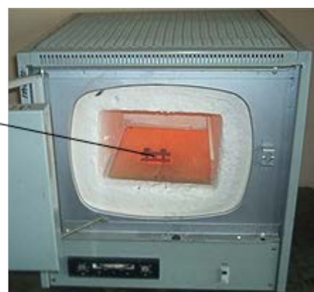
Рисунок 8.2 – Зразки для дослідження процесів, що протікають у герметичних об'ємах, при нагріванні в вакуумній камері (а) та муфельній печі (б)
