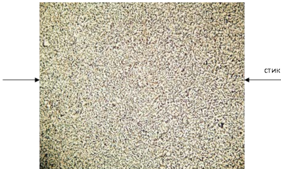
Рисунок 6.12 – Мікроструктура зварного з'єднання сталі 45 отриманого дифузійним зварюванням у вакуумі при попередньому загартуванні зразків у воду і застосуванні вуглеводневої суміші (оптична мікроскопія, x50)
