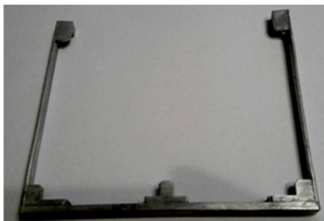
Рис. 10. Зовнішній вигляд зварного корпусного вузла спеціального призначення
