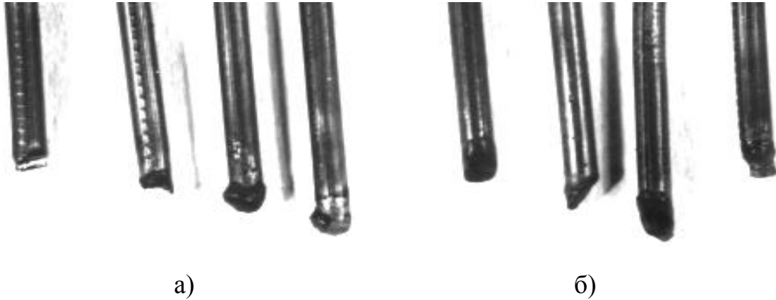
Рисунок 6 – Зовнішній вигляд торців СПД після наплавлення (укрупн. 1,5)
